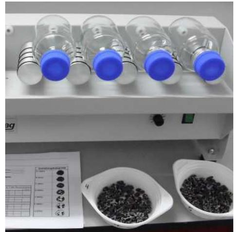
Dopo 24 ore di prova, la superficie degli inerti ricoperta da bitume deve essere superiore al 60-70% al fine di ottenere una pavimentazione avente una buona resistenza all’esposizione all’acqua.
