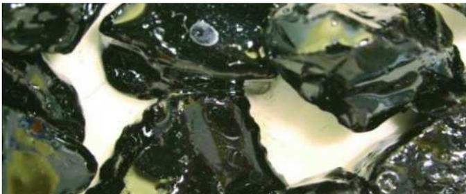
L'adesione tra bitume e aggregati rappresenta il punto critico dell'intero processo di realizzazione di una pavimentazione stradale.
