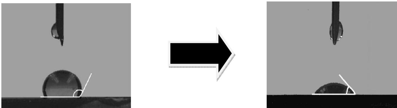
L'aggiunta di piccolissime quantità di **STARDOPE®** modifica la tensione superficiale fra bitume ed aggregati, riducendo l'angolo di contatto, ne consegue una maggiore attitudine del bitume a ricoprire gli aggregati.
