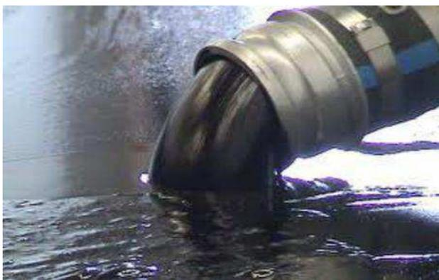
Il bitume è una miscela complessa di sostanze chimiche. Le proprietà adesive del bitume sono strettamente connesse alla presenza di gruppi acidi, per questo un bitume con un’alta acidità avrà una migliore adesione rispetto ad un bitume neutro.
