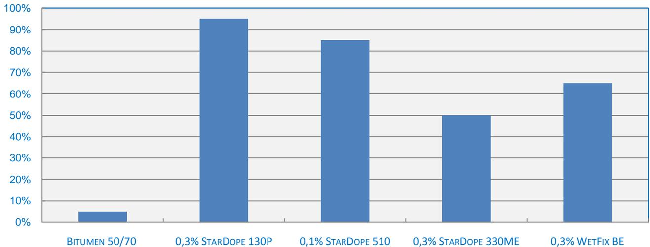
Con la prova di laboratorio UNI EN 12697-11 Parte A, denominata **“Rolling Bottle Test”**, gli aggregati vengono prima ricoperti a caldo con bitume e successivamente posizionati all’interno di bottiglie di vetro piene d’acqua a temperatura ambiente. Le bottiglie vengono fatte ruotare per un periodo di 24 ore e ispezionate ogni sei ore, dando una valutazione visiva del grado di ricopertura di bitume, in termini percentuali.
