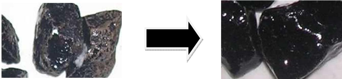
**STARDOPE®** conferisce alle pavimentazioni una maggiore resistenza all'invecchiamento rallentando il processo di ossidazione. Per effetto dell'ossidazione il bitume subisce un aumento della viscosità fino a perdere totalmente la sua flessibilità, diventando fragile e incline alla rottura.
