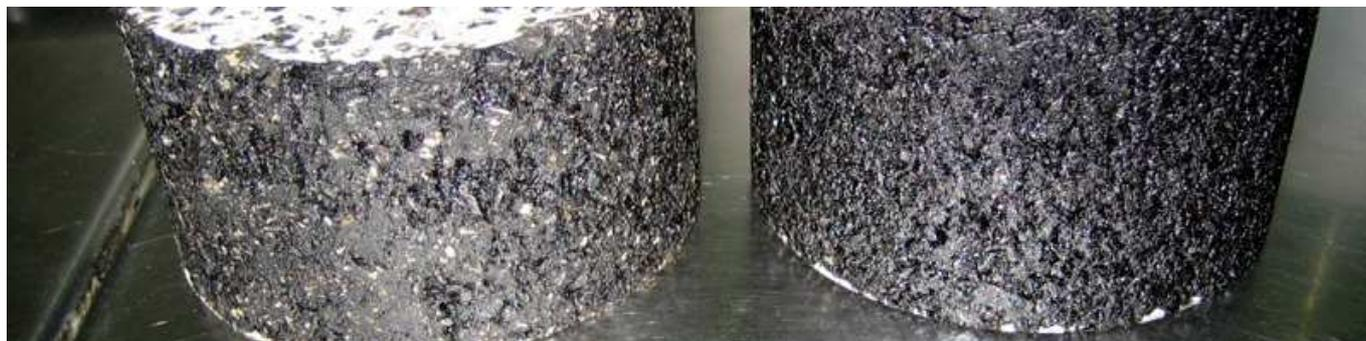
Il test consiste nell'eseguire, alla temperatura di 25°C e mediante pressa Marshall, lo schiacciamento di una formella prodotta con il conglomerato plastico invecchiato in stufa a 135°C. La formella di conglomerato viene compattata con 75 colpi per faccia.
