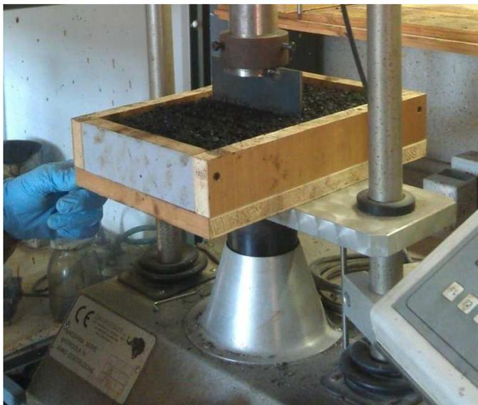
La valutazione della lavorabilità di un conglomerato plastico è stata fatta impiegando un test (MTO LS-289) che simula la resistenza che incontra una lama di una pala, adoperata da un uomo con peso ed altezza medio, a penetrare nel conglomerato plastico, rispettivamente alla temperatura di  $-10^{\circ}\text{C}$  e  $0^{\circ}\text{C}$ .
