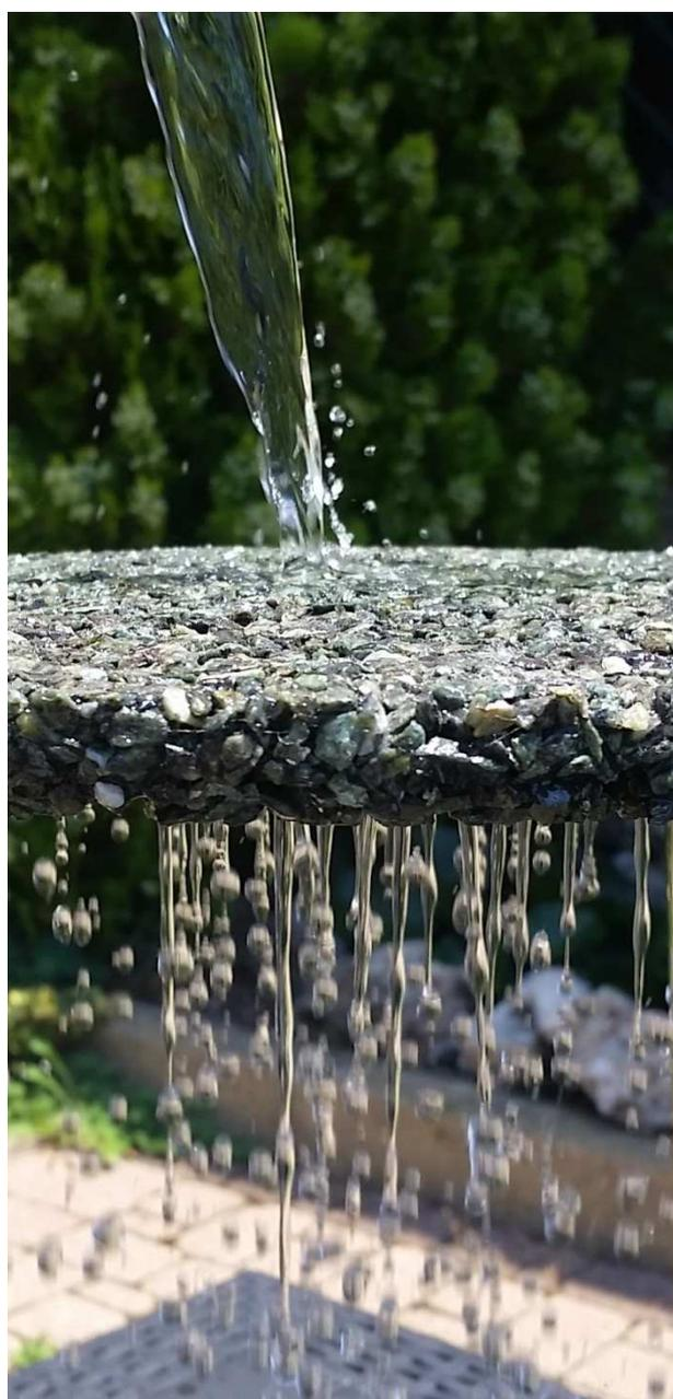
La realizzazione del pavimento è molto semplice. Si tratta infatti di mescolare, a freddo, tre componenti, i primi due (**STARPAV2K-EP** componente "A" e componente "B") con funzione di legante, il terzo sono gli inerti di varie forme, dimensioni, colori.
