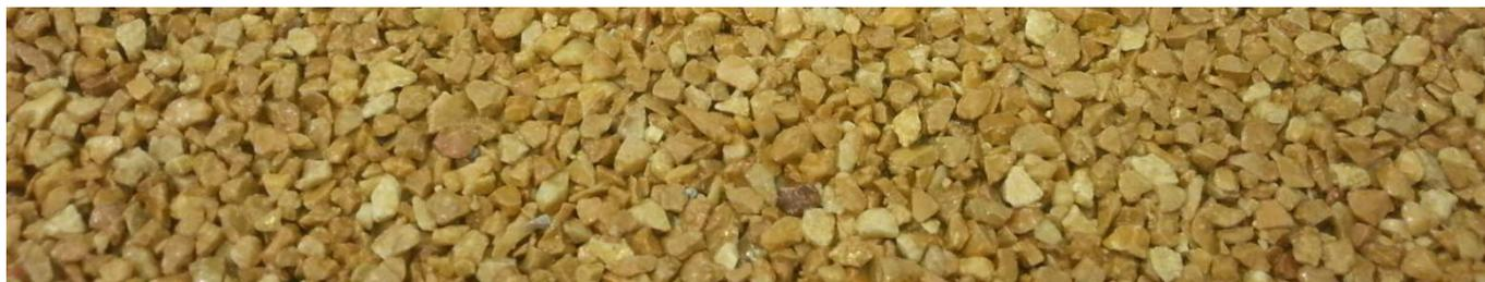
I pavimenti per esterni **STARPAV** sono permeabili e drenanti: permettono all'acqua di attraversare lo spessore della pavimentazione e di confluire verso i punti di raccolta, prevenendo il pericoloso effetto di acquaplaning, dato dal ristagno dell'acqua sulla pavimentazione.
